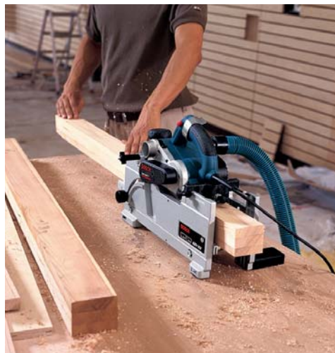
11.3. Использование рубанка с фуговально-рейсмусовым приспособлением
