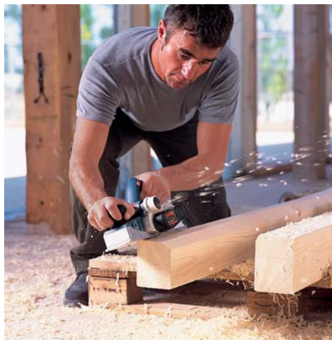
11.1. Использование рубанка для снятия фаски с деревянного бруса
