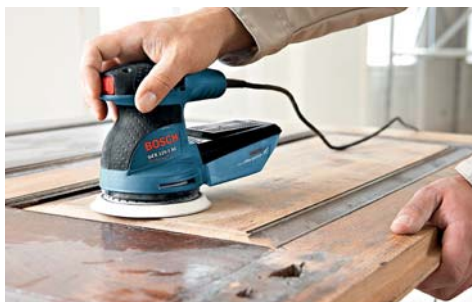
14.1. Использование эксцентриковой шлифовальной машины для шлифования древесины
