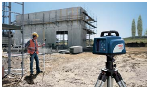
15.1. Определение разницы высот при помощи лазерного нивелира
