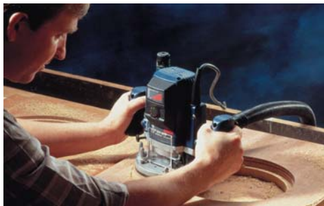
12.1. Использование фрезера для обработки заготовок от центра
