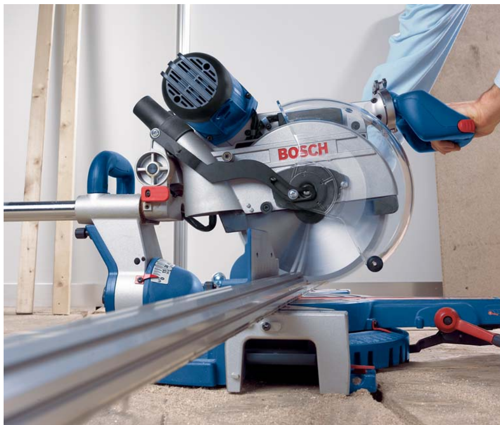
1.2. Установка торцовочной пилы на полу (в противовес размещению на верстаке)
