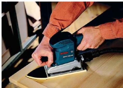
14.6. Использование вибрационной шлифовальной машины с удлиненной угловой платформой
