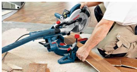
8.2. Использование торцовочной пилы для пиления ламинированных ДСП
