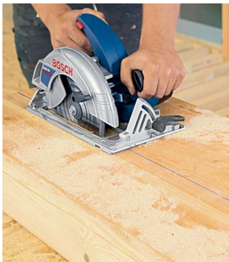
8.1. Использование ручной циркулярной пилы для пиления досок
