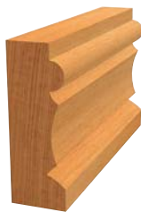
12.3. Пример профиля, сформированного профильной фрезой
