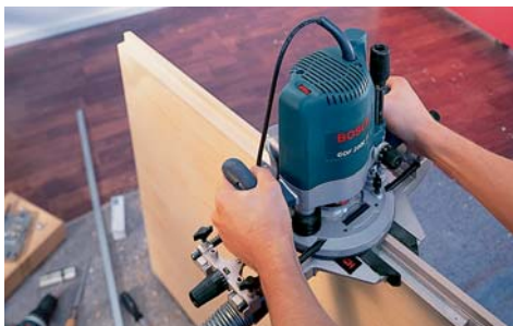
12.2. Использование фрезера для обработки кромок
