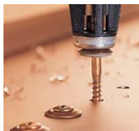
4.1. Закручивание шурупов при помощи шурупверта
