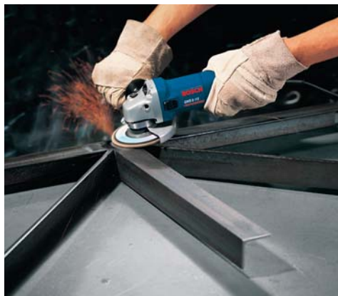
13.1. Использование УШМ для зачистки сварных швов
