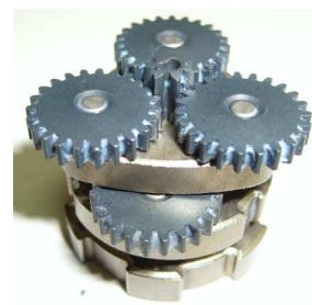
Взаимное расположение деталей в редукторе со стороны эл. Двигателя
