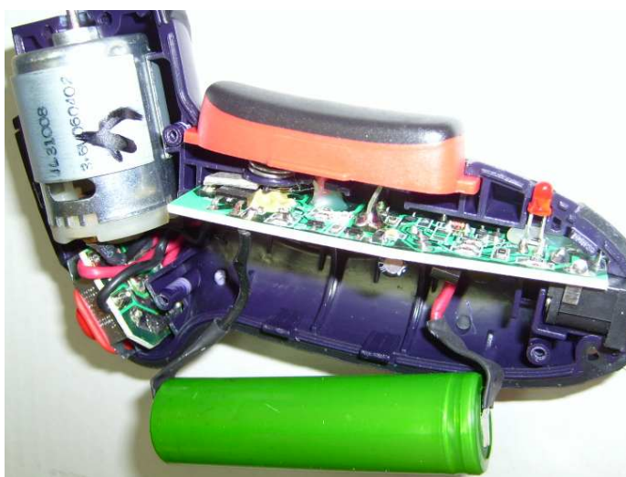
Взаимное расположение деталей в корпусе несущем - эл.двигатель в сборе
