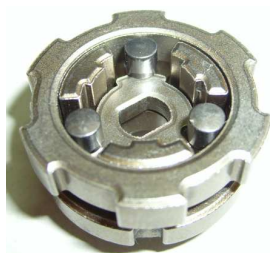
Взаимное расположение деталей в редукторе со стороны шпинделя
