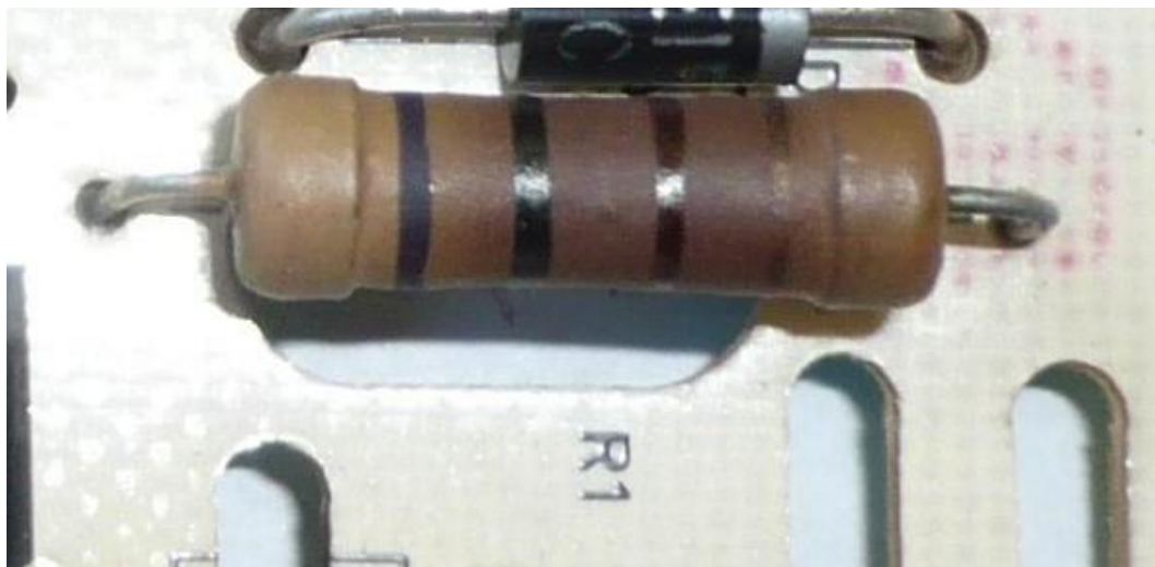
Рис. Краска на пусковом резисторе потемнела и номинал резистора нечитаем.
